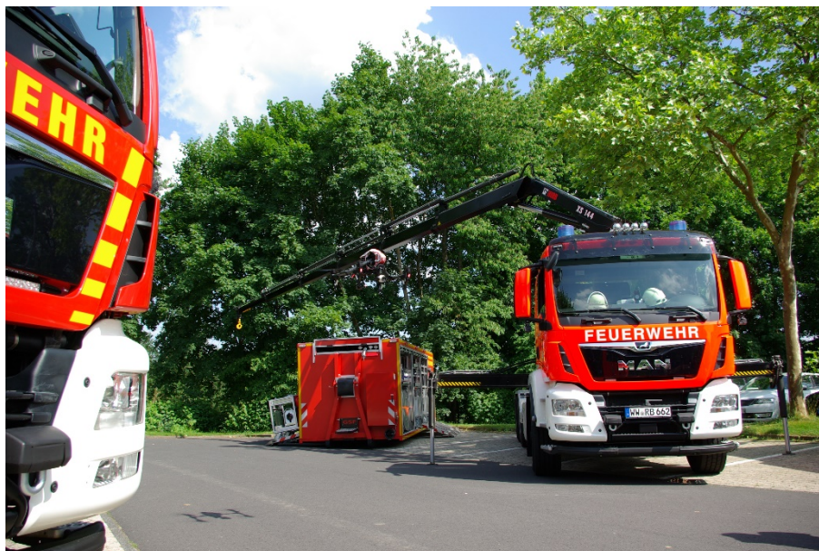
Wechselladerfahrzeuge des Westerwaldkreises
